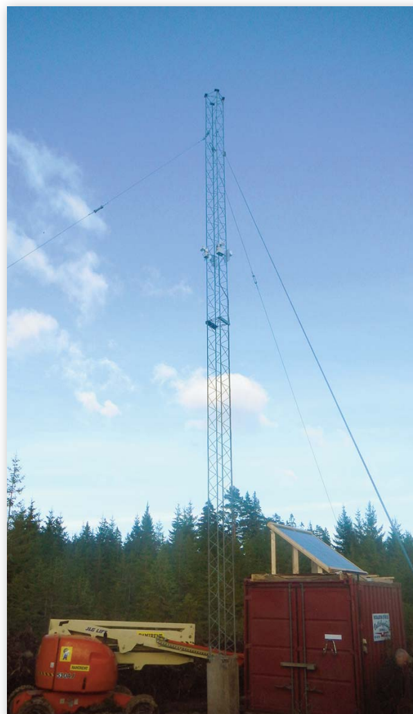
Estación de monitorización autónoma de DTBird dotada de 4 cámaras de alta definición, efectuando este otoño el censo del paso migratorio de grullas en Suecia.
