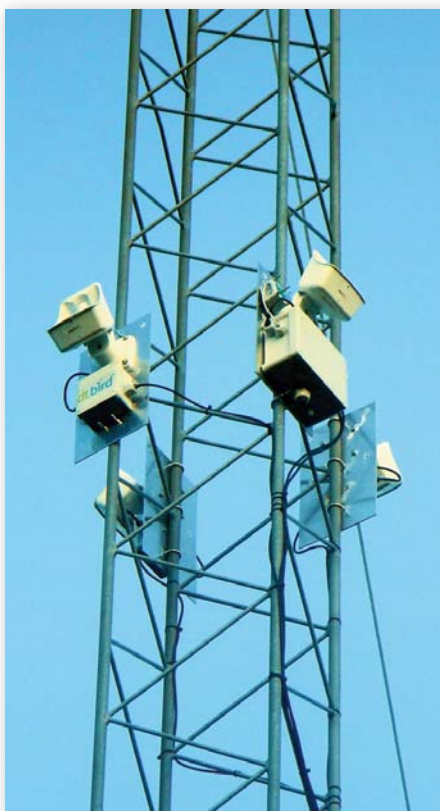
Estación de monitorización autónoma de DTBird dotada de 4 cámaras de alta definición, efectuando este otoño el censo del paso migratorio de grullas en Suecia.
